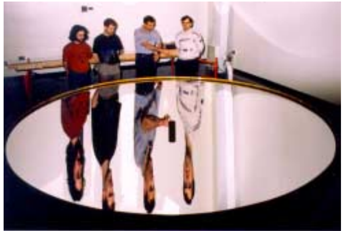
Miroir liquide de 3,7m de diamètre.
